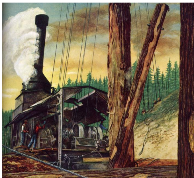
Abbildung 2: Eine der ersten Seilbahnen mit dampfbetriebener Seilwinde, zu Beginn des 20. Jahrhunderts
