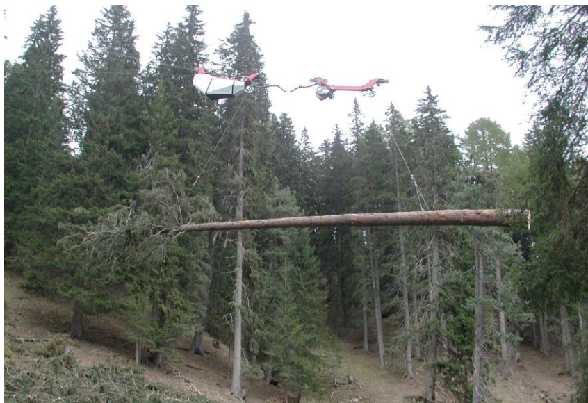
Abbildung 7: Komplette Aufhängung der Last mittels doppeltem Laufwagen
