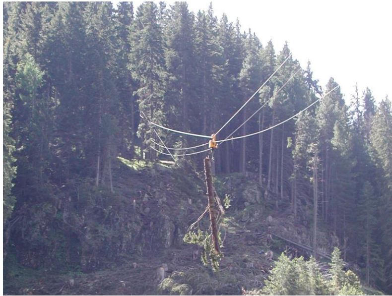
Abbildung 10: Laufwagen mit Seilen für Vor- und Rücklauf
