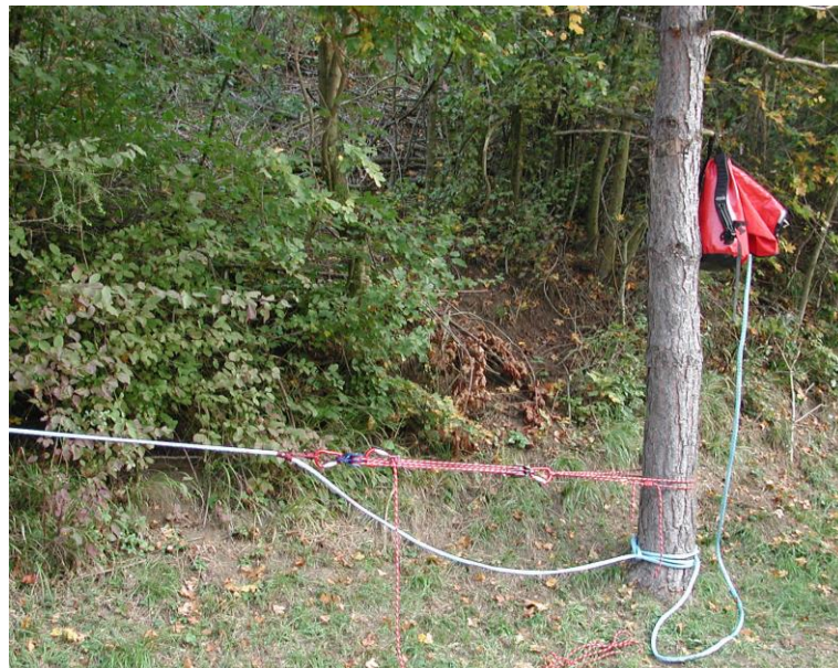
Abbildung 13: Synthetische Seile sind ohne Masten schwer zu spannen
