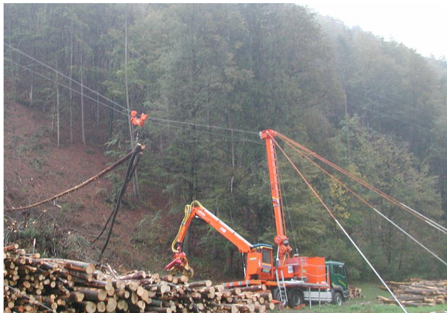
Abbildung 5: Motorisierte Station mit Gegensicherung mittels synthetischer Seile
