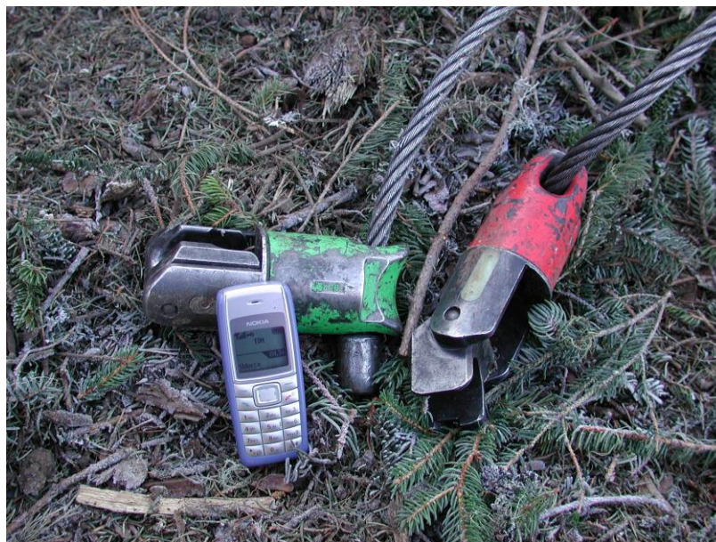
Abbildung 8: Die auf dem Markt verfügbaren ferngesteuerten Choker könnten verbessert werden
